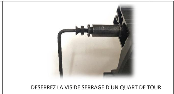
PROBLÈME : AU MOMENT DE L'ASSEMBLAGE DE LA PARTIE AVANT, LA VIS DE SERRAGE ET LE CADRE NE SONT PAS PARFAITEMENT SERRÉS L'UN CONTRE L'AUTRE.
