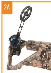
Toute la puissance sera transférée à la manivelle. Tournez lentement la manivelle dans le sens contraire des aiguilles d'une montre [vers l'arrière] jusqu'à ce que la corde arrive au niveau de la bande d'arc et qu'il n'y a plus de pression exercée sur la poignée.
