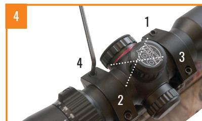
4. Lorsque le viseur optique est positionné correctement et que le réticule est aligné avec les branches d'arbalète, serrez les vis des anneaux; faites attention de le faire en serrant d'une vis à l'autre en croisé et en serrant chaque vis d'un quart de tour à la fois pour éviter d'altérer la position du réticule.
