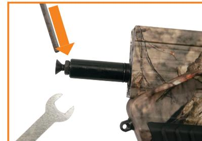
Desserrez le contre-écrou de la barre de fixation
