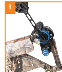
8. Enlevez les deux crochets de la corde de l'arbalète. Maintenez la prise et laissez le ressort de rappel enrouler la corde automatiquement. Rangez les crochets de la manivelle dans la zone de conservation à l'avant.
