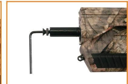
Desserrez la vis d'arrêt avec une rotation ¼ anti-horaire
