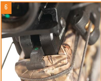
6. Après avoir vérifié que le crochet du mécanisme de gâchette a capturé la corde de l'arbalète, placez immédiatement le cran de sûreté à la position « SAFE » (sûreté) en le déplaçant vers le bas.
