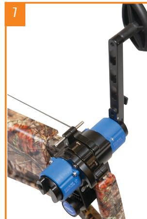
7. Maintenez une pression vers l'avant sur la poignée de la manivelle, puis pressez sur le verrou de déblocage pour le placer en position « RELEASE » (relâcher) afin de permettre aux deux crochets de se libérer de la corde.
