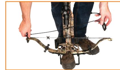
Placez fermement votre pied bien au fond de l'étrier, levez le centre de la corde avec le Tendeur Charger EXT (se référer aux Instructions de chargement, p.13 jusqu'à ce que le loquet du mécanisme de détente capte la corde du Cordeur.
