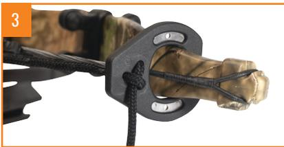
Appliquez une pression sur la poignée de la manivelle et placez le Charger EXT en position « RELÂCHER » (RELEASE), pour que la charge soit placée sur le loquet, et non pas sur les crochets du Charger EXT.
